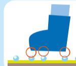
水をはじいて玉のような状態になるため、水に触れる面積が小さくなり滑りにくくなります。
